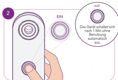
Schalten Sie das Port Locator ein, indem Sie die Taste drücken und sie loslassen, sobald der weiße Licht-Ring EINGESCHALTET ist.
